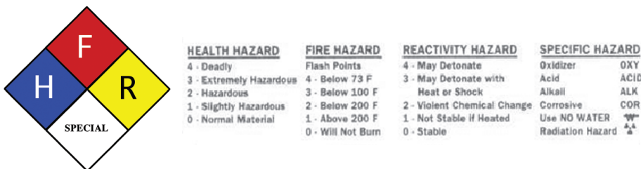
รูปที่ 1 แสดงสัญลักษณ์แสดงอันตรายตามระบบ National Fire Protection Association (NFPA)
